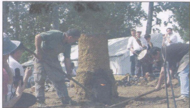
Un moment très attendu et spectaculaire : l'ouverture du bas-fourneau, l'appartenance de la lave en fusion et l'extraction de la « loupe » ferreuse.
